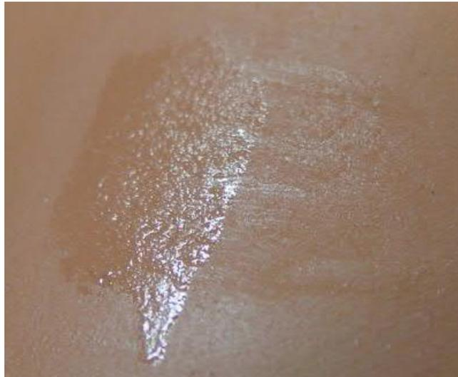
Links im Bild erkennt man die mattierende Wirkung des Lösungsmittels "Finisher" gegenüber der unbehandelten Reparatur-Stelle und wie sich die mattierte Oberfläche nun im Gesamtbild zur normalen TPE-Oberfläche auswirkt.
