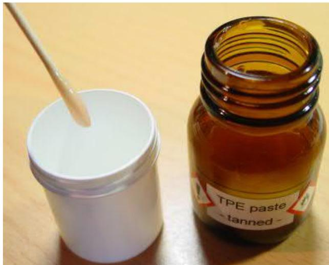
Anschließend entnehmen wir mit dem Zahnstocher etwas mittlere TPE-Paste aus dem Behälter, geben diese in das Mischgefäß und verrühren dieses zu einer dünnflüssigen TPE-Paste.
