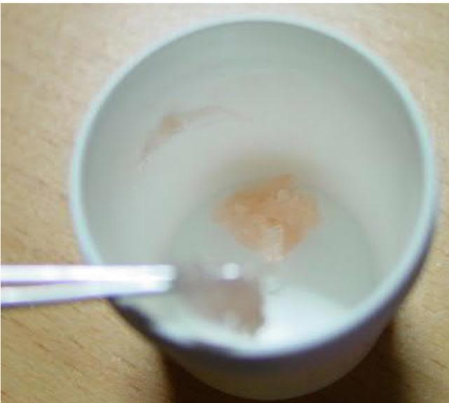
Getrocknete Reste der TPE-Paste aus dem Mischgefäß lassen sich ebenso entfernen.
