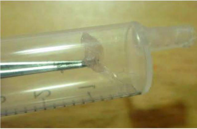
Reste der TPE-Paste, welche sich in den Spritzen befinden, lassen sich nach dem Austrocknen einfach mit der Pinzette abziehen.
