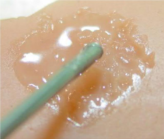
Die Ausfransung wird nun mit dem Lösungsmittel "Preparer" (wie bereits gezeigt) vorbereitet.
