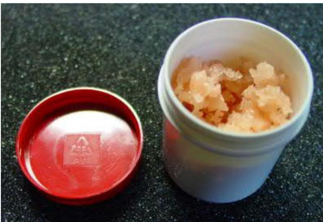
Mit dem zerkleinerten TPE-Material und der TPE-Paste aus dem Braunglas-Behälter lässt sich dickflüssige TPE-Paste und dickes TPE-Gelee herstellen.
